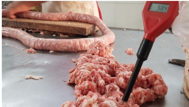
Figura 10: Medición de pH sobre masa de salame en la fábrica de chacinados y despostadero “Manjares Serranos”.
