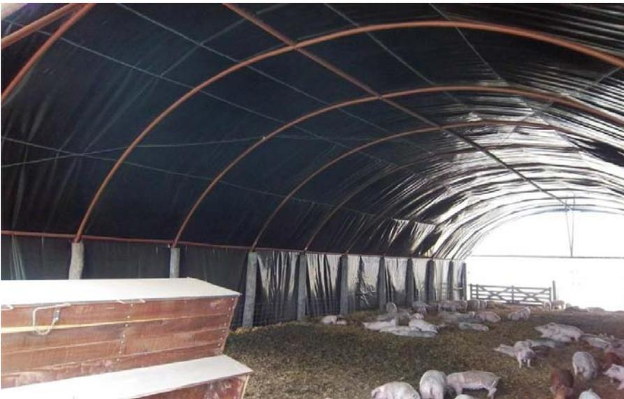
El frentes norte, es abierto, y el sur con cortinas para evitar el excesivo enfriamiento durante el invierno y facilitar la ventilación en verano.
