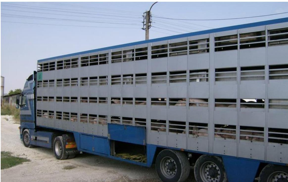
Fotografía 2: Camión con semirremolque de tres pisos para el traslado de cerdos donde se puede observar el sistema de ventilación pasivo y zócalo (EcuVet Porc)
