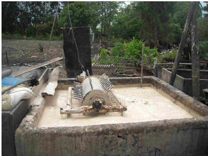
Foto 2. Mezclador de alimento (lácteos vencidos + pan + levadura cerveza).
