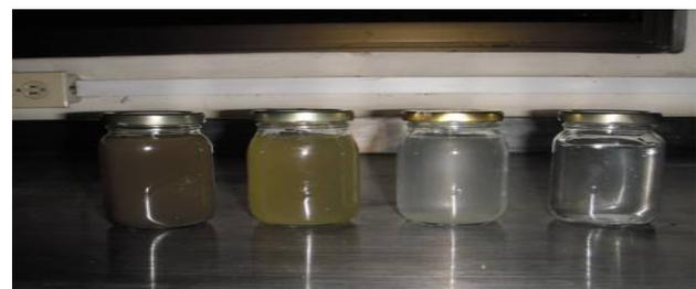
Figura 12. Agua de salida de los subsistemas. De izquierda a derecha: agua de entrada, agua tras el tratamiento en el sistema S1, agua tras el tratamiento en el sistema S2 y finalmente agua tras el tratamiento S3.
