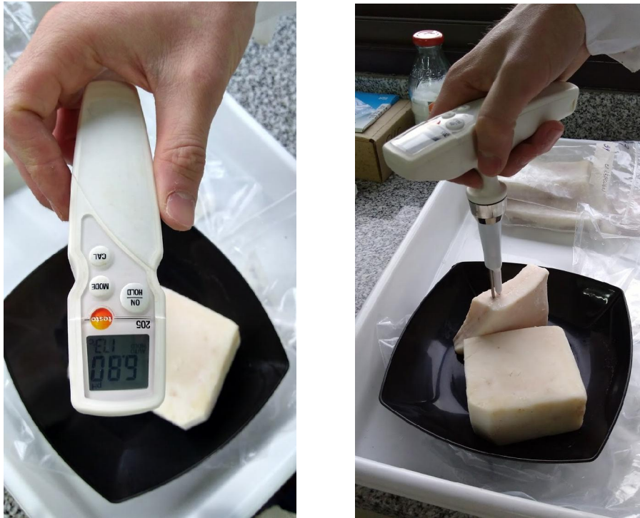
Figura N° 9: Medición del pH del tocino dorsal con el pHmetro Testo® 205.
