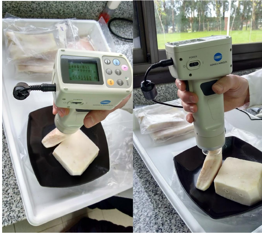
Figura N° 8: Determinación del color de la grasa dorsal del cerdo mediante el colorímetro Minolta® CR-400.
