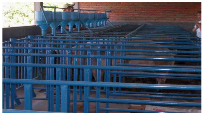
**Fig. 3. Sistema semiautomático de Tolva individual en el área de gestación.**
