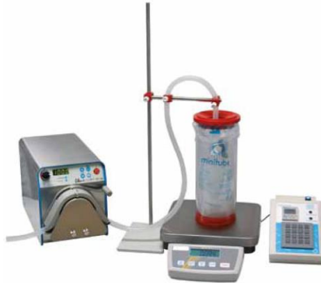
Figura 23: Dilución del material seminal con el SmartDispenser desarrollado por Minitüb, Tiefenbach, Alemania
