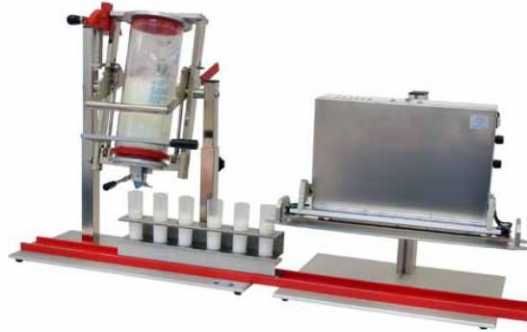
Figura 29: Modelos Hypacker y Twinpacker para el envasado automático y computarizado. Minitüb, Tiefenbach-Alemania
