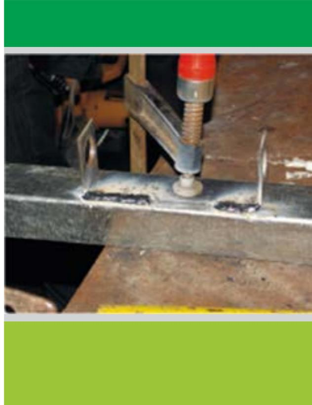
Una vez preparado el lugar, debe comenzarse el ensamble por una esquina, procurando que el ángulo entre los dos módulos sea aproximadamente de 90°, ello permite que, siguiendo una línea recta con los módulos siguientes, el corral quede instalado de manera más segura, evitando puntos débiles donde el animal pueda romper la instalación. También puede optarse por sostener los marcos provisoriamente con alambre, lo que posibilita colocar el perno y clavarlo al suelo de manera más sencilla.
