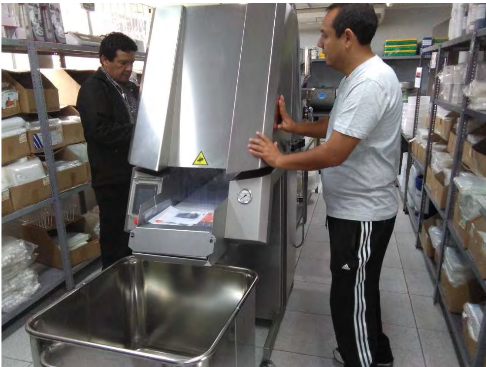
Ilustración 52: Inyectora multiaguja para 68árnicos con la cubierta puesta y depósito de salmuera ambulante. Fuente: Propia.
