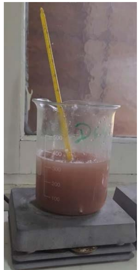
Muestra con la solución sobre la placa calefactora con agitación y control de temperatura.
