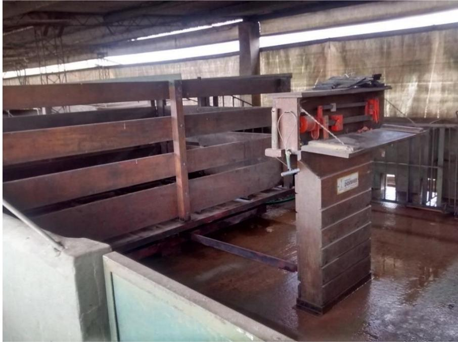
**Figura 6:** Balanza mecánica utilizada para pesar a los animales que excedían los 20 kg de peso individual promedio, en una granja porcina intensiva en el partido de Tandil, Buenos Aires.
