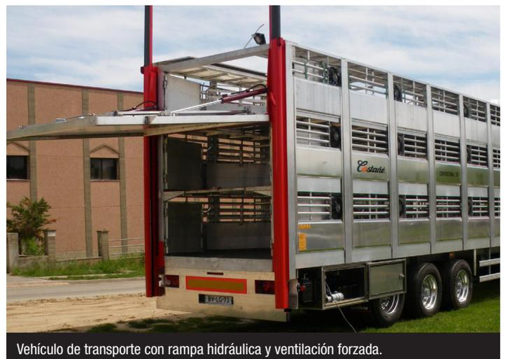
Vehículo de transporte con rampa hidráulica y ventilación forzada.
