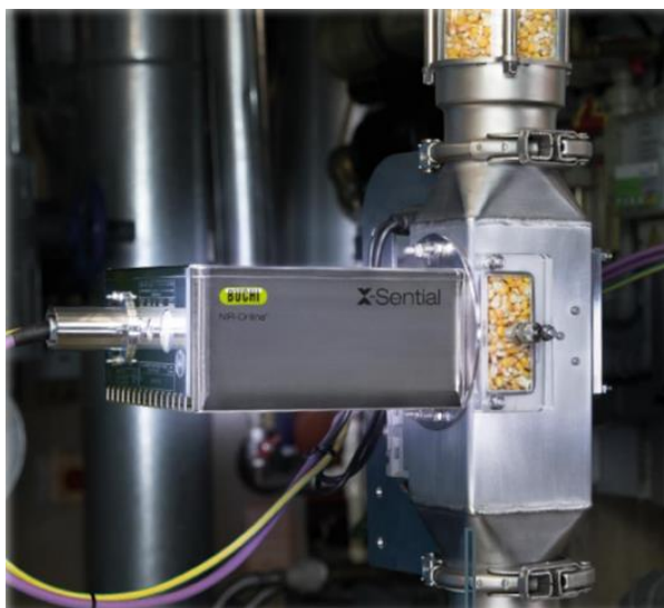
Figura 1. Equipo de espectroscopía de infrarrojos cercano (NIR) (foto proporcionada por la empresa ADM Animal Nutrition Spain).
