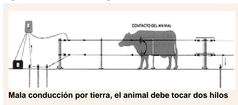
Figura 4. Retorno de tierra por alambre
